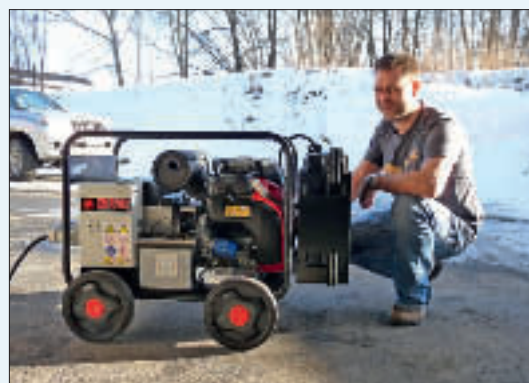
Vegard Nilsen ved siden av vårt nye bensindrevne strømaggregat.
